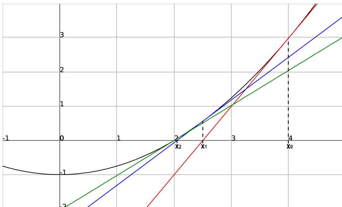
Abbildung 1: Beispiel zum Newton-Verfahren: drei Schritte mit Startwert x_0=4
